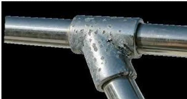
Abb. 11 Aluminium-Korrosion
